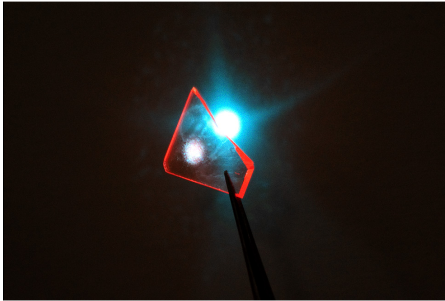
FIGURE 8 – Luminescence d'un cristal de ZnSe excitée par un laser argon (488 nm).
