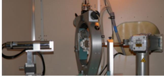
Figure 2.17 : Dispositif de mesure de texture par DRX.
