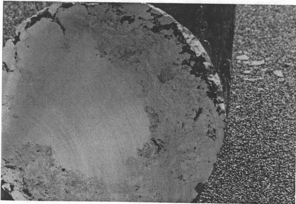
Photo 7 : Coupe transversale d'un lingot de 2024 (alimentation par copeaux)
