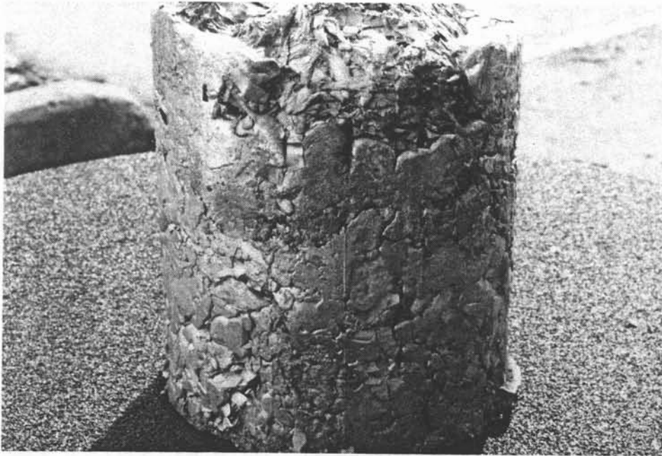
Photo 6 : Lingot de 2024 \phi 100 - élaboré avec alimentation par copeaux
