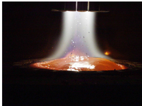
Fig. 1 : Jet de plasma à la surface d'un dôme de Silicium
