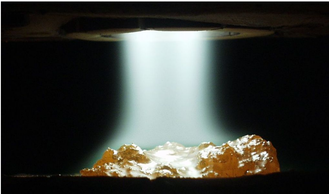
Fig. 5.27: Vue de la masse liquide. On observe le changement de l'interface suite à l'injection de l'oxygène et de l'hydrogène.
