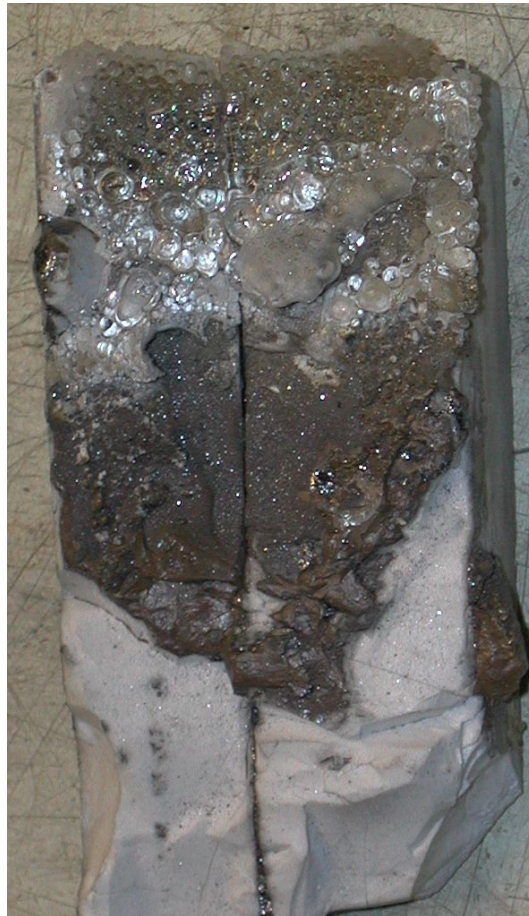
Fig. 5.3: Les « doigts » de silice qui composent le garnissage du creuset sont vitrifiés sur une épaisseur de 3 à 4 mm à la partie supérieure, exposée au plasma.
