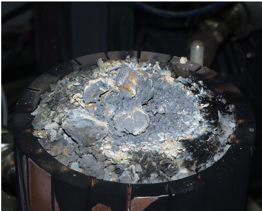
Fig. 5.18: Matériau issu du procédé de pré fusion après exposition sous plasma.
