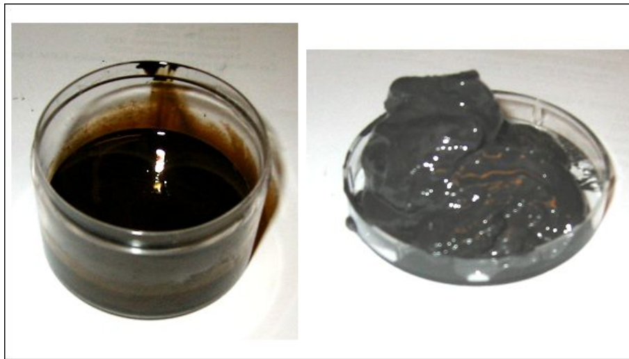
Fig. 5.11: Le matériau à différentes étapes du traitement : A gauche les slurries te qu'ils sont récupérés après la phase de sciage des blocs, à droite le sludge obtenu après centrifugation.
