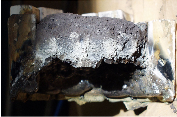
Fig. 5.23: Vue de la charge à la fin de l'expérience. Sur la partie supérieure, on voit clairement la cavité formée par les gaz qui se sont formés.
