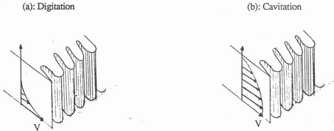
Fig. n°37: Instabilités de lubrification d'après TAYLOR
