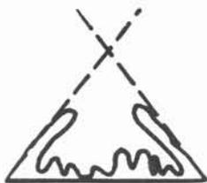
Les cotés du triangle sont constitués de jets issus du pied des bourrelets. Lorsque la vitesse augmente, sous l'effet d'entraînement de l'air, ce triangle décolle de la roue, et vient, pour les très hautes vitesses, tout contre la lame incidente.
