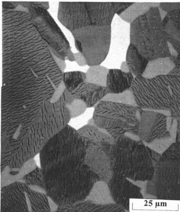
Figure 4.12 : Micrographie d'une zone de l'alliage 16 recuit à 1200°C pendant 15j montrant un mélange des trois phases \alpha , \beta et \gamma .
