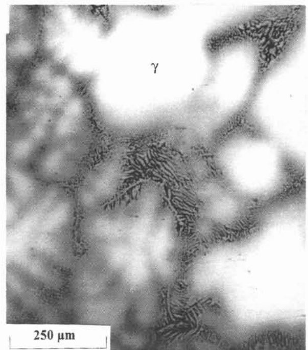
Figure 4.23 : Micrographie d'une zone de l'alliage 4.14 montrant la précipitation de \sigma dans les dendrites primaires de \gamma à rapprocher de celle de la nuance ternaire 3.
