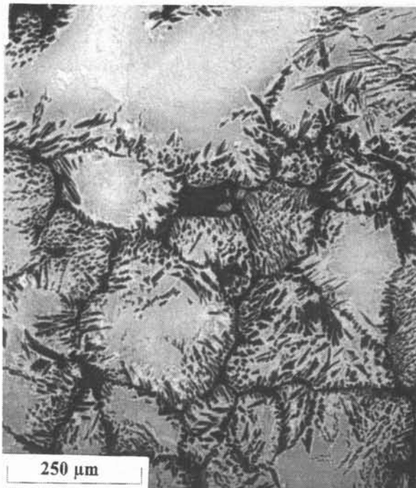
Figure 4.22 : Micrographie de l'alliage 8.8 montrant les dendrites primaires de \gamma et la transformation à l'état solide issue d'une réaction péritectique.
