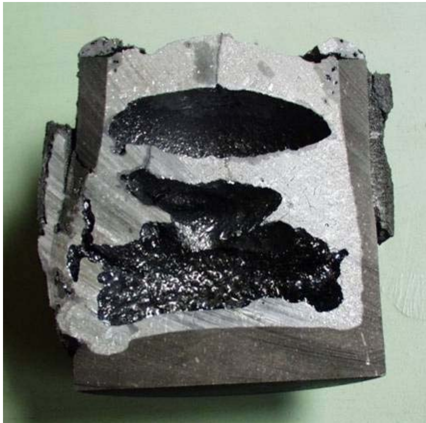
Figure IV-23 Coupe d'une charge de silicium traité à haute puissance (100 kW) et solidifié dans le creuset graphite
