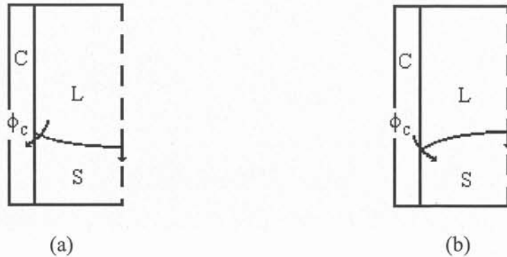
Figure 2.4. Courbure de l'interface solide-liquide : a) concave ( k_S < k_L ) ; b) convexe k_S > k_L .
