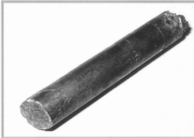
Figure 5.3. Cristal de Ga_{0.85}In_{0.15}Sb obtenu à une vitesse de tirage V = 0.4 \mu m/s .
