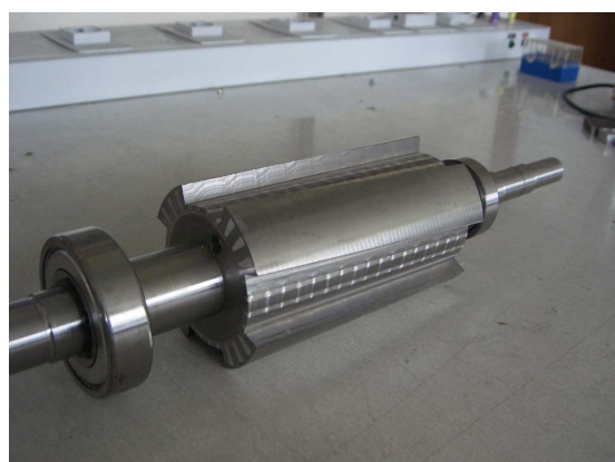
Rotor après usinage
