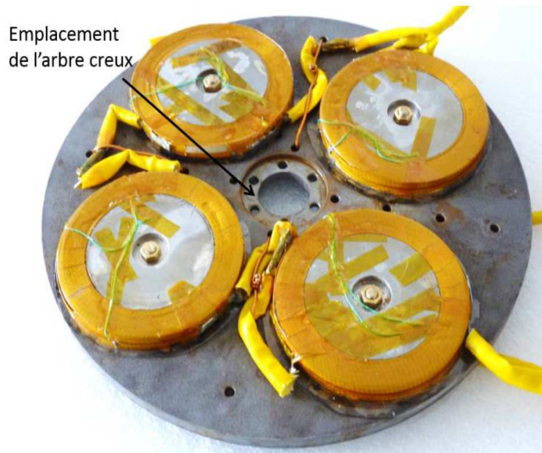
Figure 4.19 : Bobines en BSCCO placées sur un disque ferromagnétique [DOL 15].
