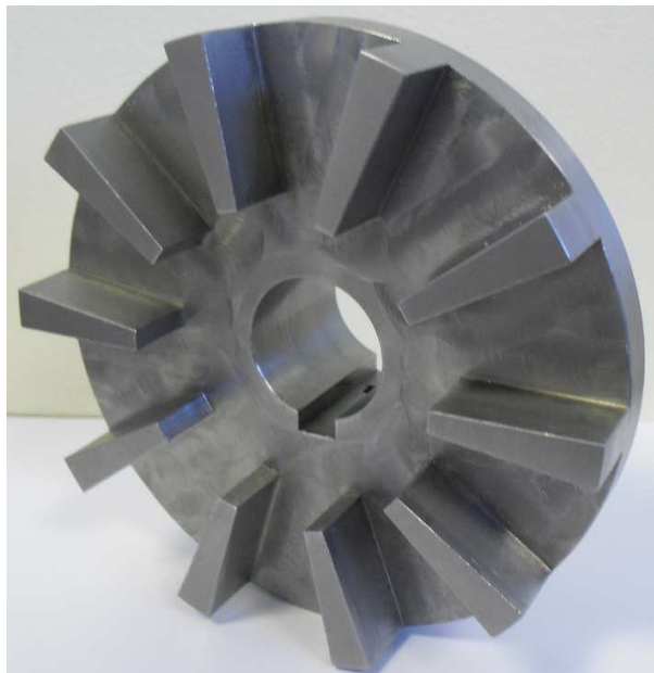
Figure 5.3 : Accouplement magnétique à réluctance variable à flux axial (partie avec les saillances magnétiques).
