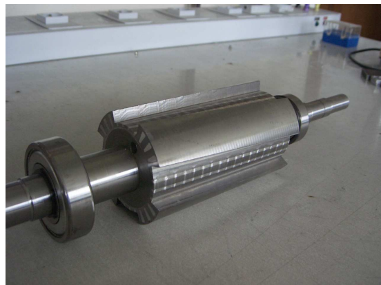
Rotor après usinage
