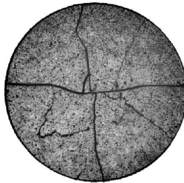
FIG. 1.12: Céramographie d'une pastille REP fissurée par le gradient thermique, après un cycle d'irradiation - plan transversal de la pastille
