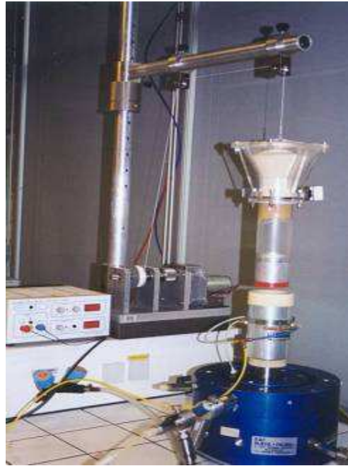
Figure 2.8. Vue du pluviateur avec dispositif de relevage. (Benahmed, 2001)
