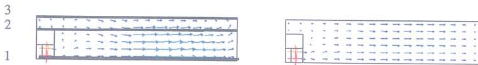
figure 4.24 : vecteurs vitesse dans la section de la cuve au niveau de la sortie des jets ; colonne de gauche : écoulement sans champ ; colonne de droite : écoulement avec imposition de champ « localisé »
