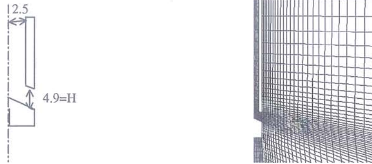
figure 4.27 : busette 2D équivalente ; a modèle ;b. maillage.
