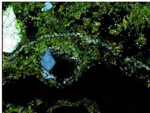
Figure 2.5 – Observation sous lumière polarisée d'une fissure complètement remplie par de la calcite (Nijland *et al.*, 2007).
