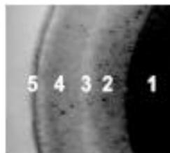
Figure 1.15 – Zonation d'une pâte de ciment dégradée par lixiviation, d'après Adenot (1992).
