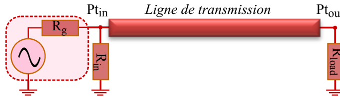
Figure 3.25 – Circuit de simulation pour la validation du modèle de la ligne de transmission.
