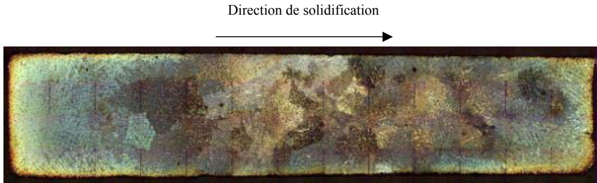
Figure E-40 : Macrostructure réalisée sur l'échantillon n°7. Plan horizontal.
