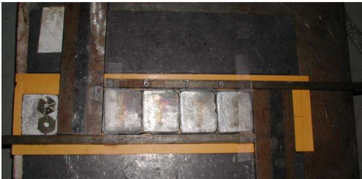
Figure E-28 : Photo des échantillons dans leur moule, avant radiographie.
