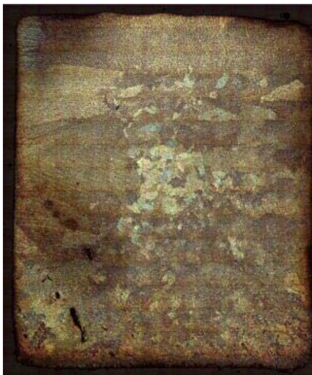
Figure E-39 : Macrostructure de la face médiane de l'échantillon n°5. Vitesse de refroidissement de 2 K.mn^{-1} .
