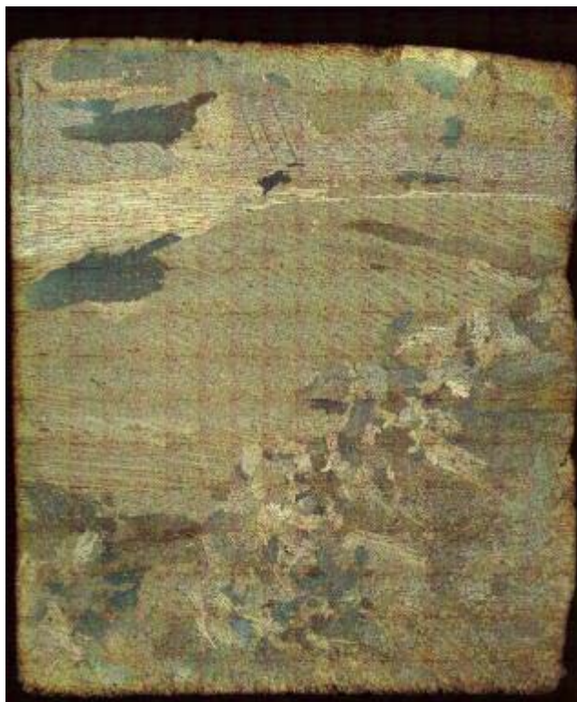
Figure E-38 : Macrostructure de la face extérieure de l'échantillon n°5. Vitesse de refroidissement de 2 K.mn^{-1} .
