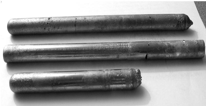
Figure 3.2 : Charges GaSb et GaInSb élaborées par la technique de brassage et chauffage par induction électromagnétique ( \Phi=11 \text{ mm} ).
