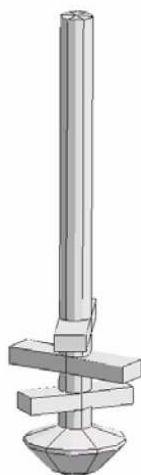
figure I.6 : Géométrie de l'agitateur de type « gobber » (Op de Camp et al. (2002)).
