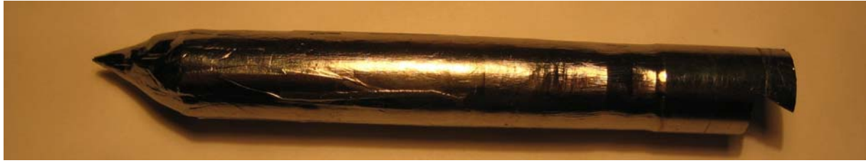
Figure. Lingot d'InSb totalement démouillé solidifié à bord de FOTON [118].
