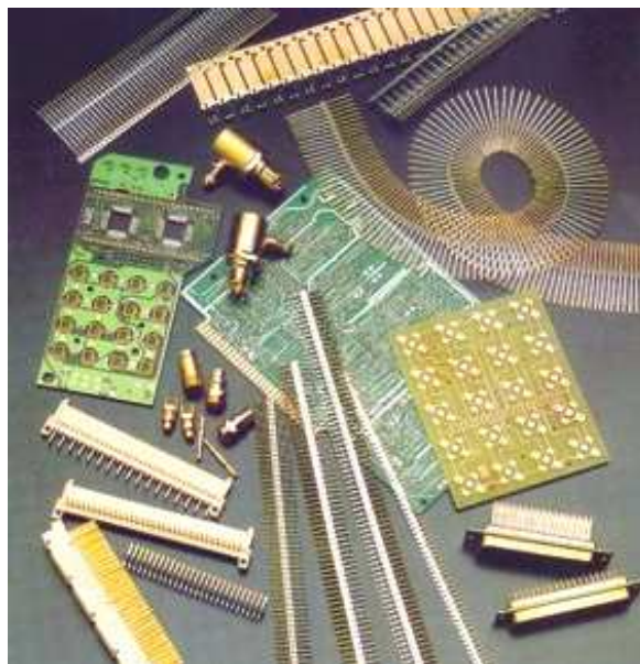
Figure 2.1. Composants électroniques réalisés par procédés d'électrodéposition de cuivre et de ses alliages, (P. Olivas [29-30]).
