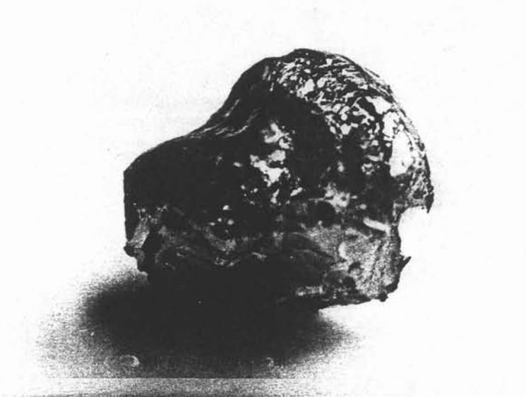
Fig. 4.15 - Photo de l'échantillon B5 montrant les cristaux hexagonaux sur la surface supérieure.
