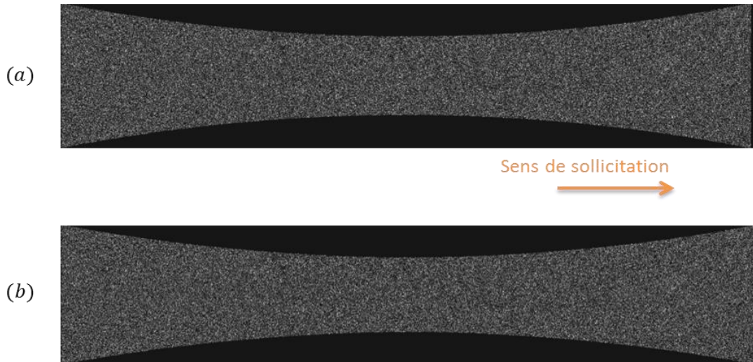
FIGURE 4.31 - Image de référence (a) et déformée (b) obtenues par la procédure de génération d'image de synthèse.
