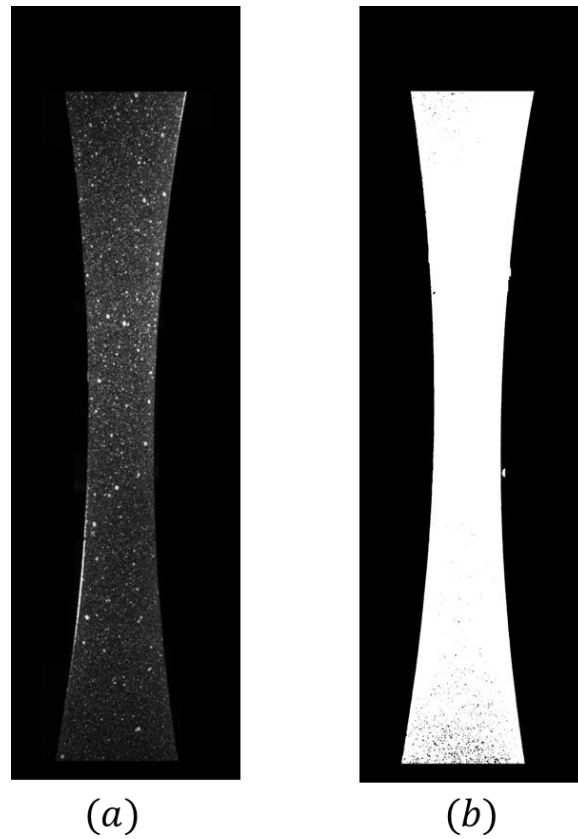
FIGURE 3.13 - Masque de l'image de référence permettant d'ôter les objets autres que l'échantillon (a) et sa binarisation (b).
