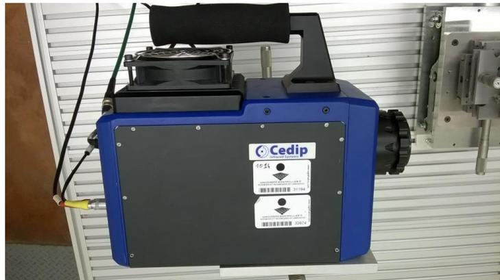
**FIGURE 3.9** - *Caméra InfraRouge Titanium SC7000.*
