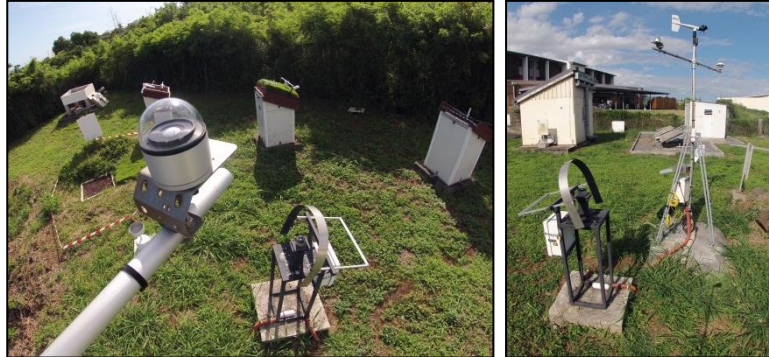
Figure 63 : Luxmètres extérieurs pour les éclairagements diffus et global
