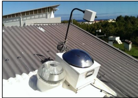
Figure 60 : Le TSI positionné dans l'axe du collecteur
