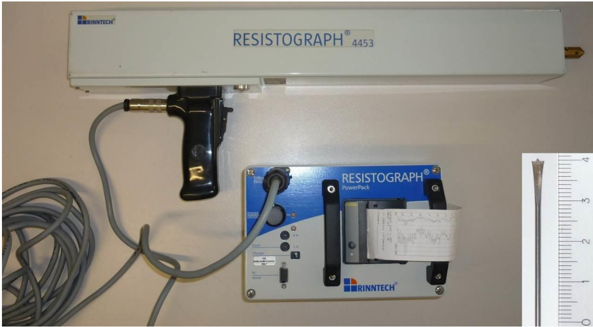
Figure 14 : Résistographe Rinntech relié au module de stockage et détail de l'extrémité de l'aiguille foreuse.
