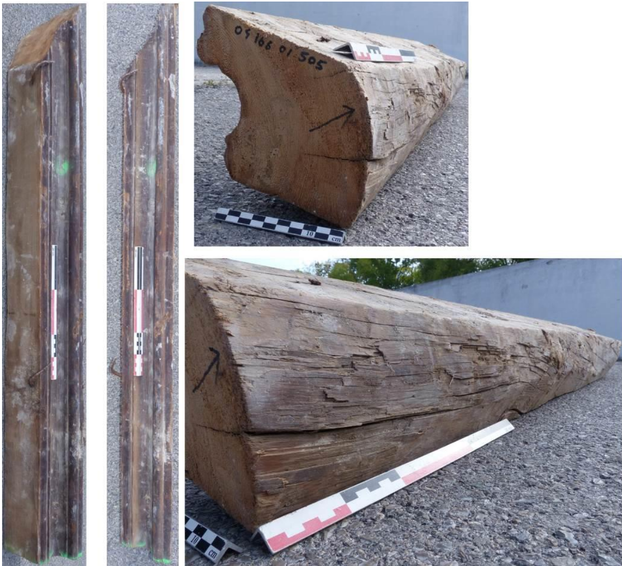
Figure 256 : Moulure 0416601_505. Une section de 1 m de longueur a été prélevée. La face courbe de cette pièce de bois n'a pas été équarrie et le chemin de mesure atteint bien le dernier cerne de l'arbre.
