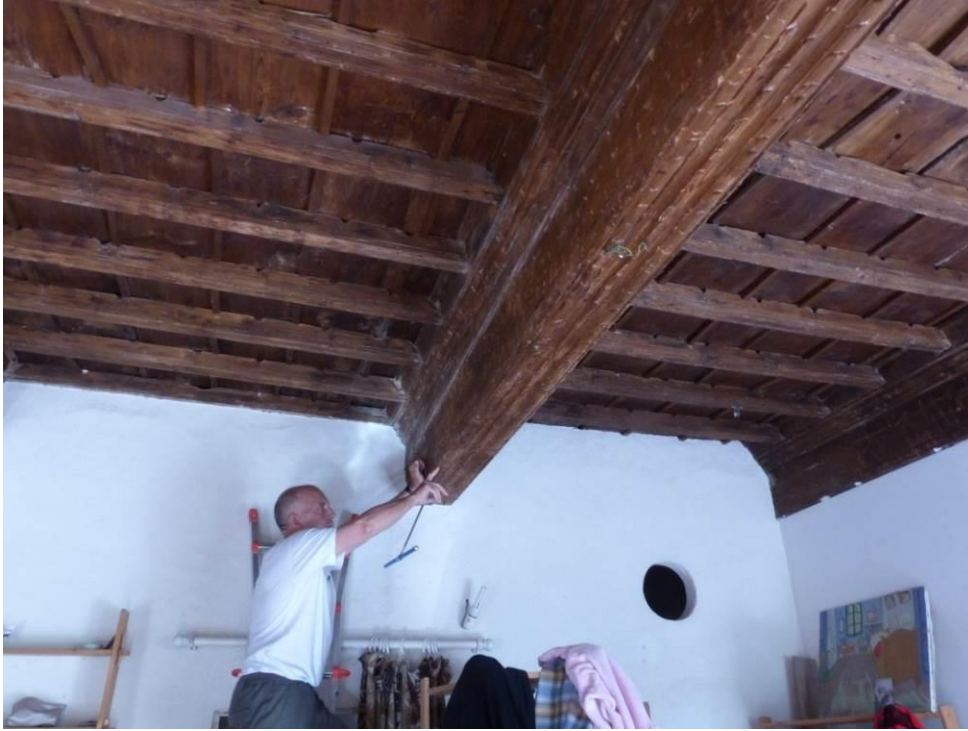
Figure 696 : Carottage à la tarière de Pressler de la poutre 03 par F. Guibal (Blégiers, Prads-Haute-Bléone).
