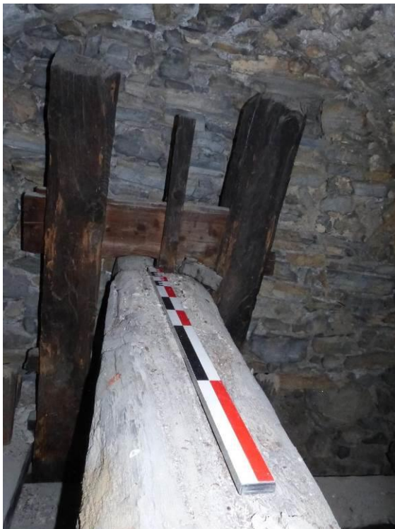
Figure 165 : Pressoir de l'Encombrouze (0515108), vue de la partie nord du levier (0515108_06), qui repose entre les jumelles.
