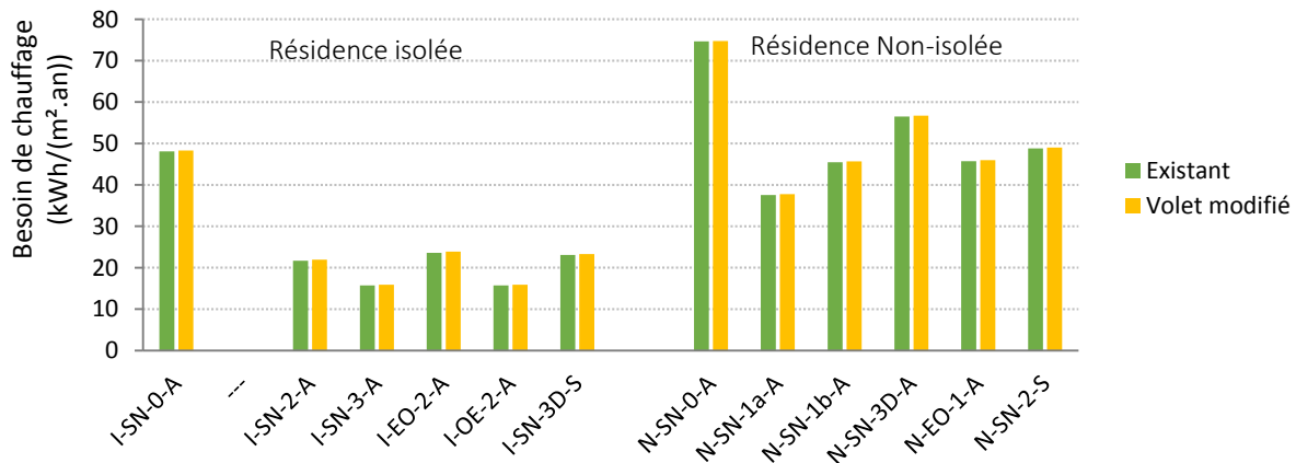
FIGURE 4.42 : Besoin de chauffage pour atteindre la température de confort minimal T_{C.3} pour l'existant et pour la modification de la typologie du volet de l'auteur
