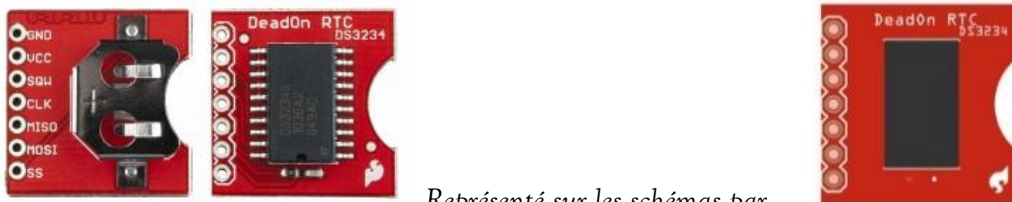
FIGURE 2.51 : Photographie de l'horloge temps réel (RTC) Roboshop.com
