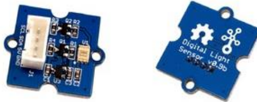
FIGURE 2.48 : Photographie du capteur de luminosité TSL2561 Lextronic.fr
