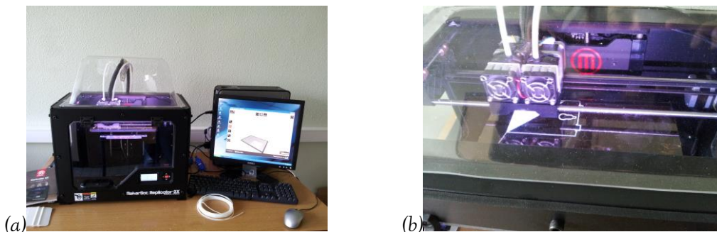
FIGURE 2.59 : Photographie (a) de l'imprimante MakerBot : Replicator 2x et (b) de l'impression d'un couvercle du boîtier de l'auteur
