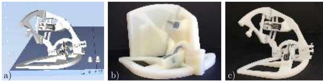
FIGURE 4.20 – Vues du deuxième dispositif : a) durant le pré-traitement, b) après fabrication, c) après post-traitement.
