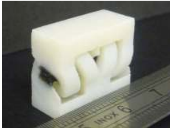
FIGURE 2.22 – Photo de la liaison HSC après fabrication.
