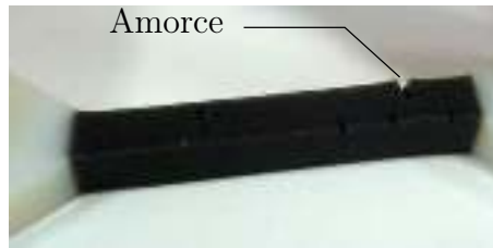
FIGURE 2.14 – Photo d’une éprouvette avec amorce de rupture.
