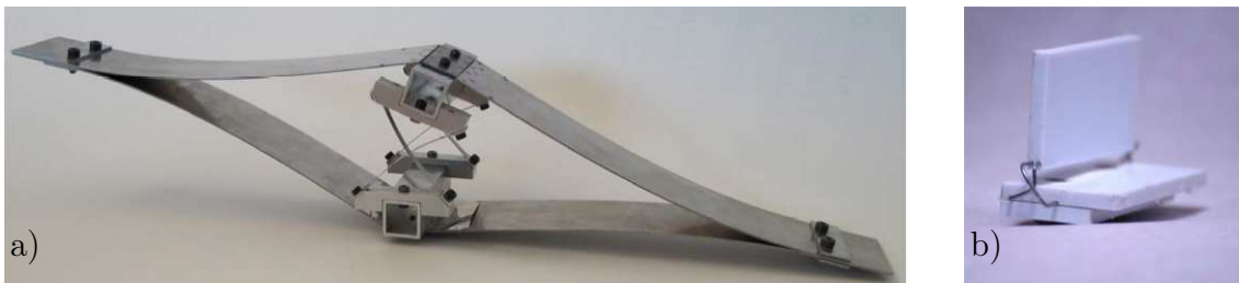
FIGURE 3.2 – Exemple de liaison pivot compliante équilibrée statiquement : a) système développé par Morsch et al. [Morsch 2010], b) Système développé par Jensen et al. [Jensen 2011].
