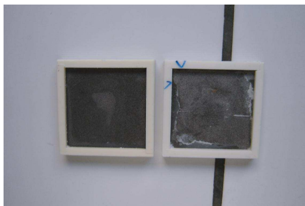
FIG. C.2 – Dispositif expérimental : exemple de plaques enrobées.
