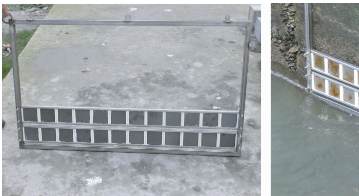
FIG. C.5 – Dispositif expérimental : support des échantillons pour le site de Peniche (gauche) et aspect de l'acier après 24 heures d'exposition (droite).
