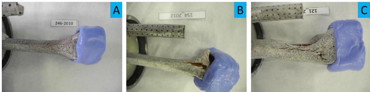
**Figure 0-4 :** Principale type de fracture trouvée dans les expériences. A. Colles' fracture (raccourcissement radial). B. Barton fracture (volar). C. Fracture. Complète.
