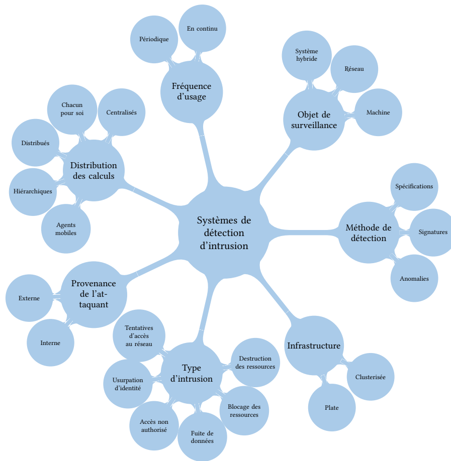
FIG. 3.2 : Critères de classification pour les systèmes de détection d'intrusion
