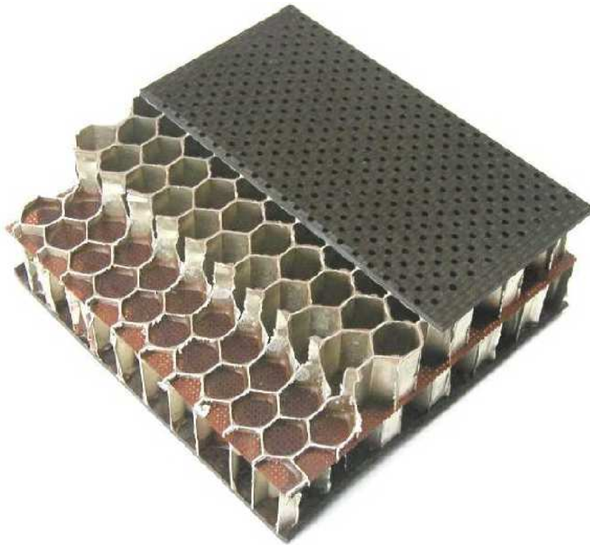
FIGURE 1.1 – Traitement acoustique de paroi (« liner ») utilisé dans les turboréacteurs. (image extraite de la thèse de Roche [50]).
