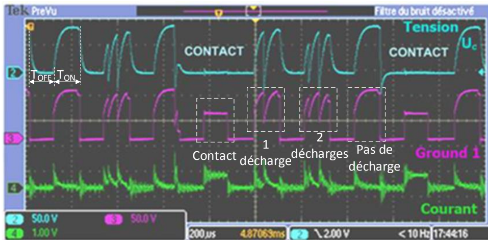
Figure 45 – Capture d'écran par oscilloscope des décharges en cours d'usinage. En bleu : d.d.p. aux bornes de C_C . Violet : d.d.p. entre le point POL et le point de référence GND2. Vert : courant qui traverse l'outil ( 1V=1A ). R_b = 0 \Omega
