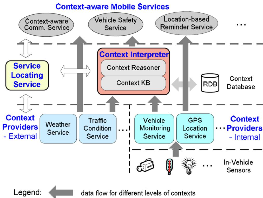
Figure 1.10 — Architecture de la plateforme SOCAM [Gu et al., 2005].
