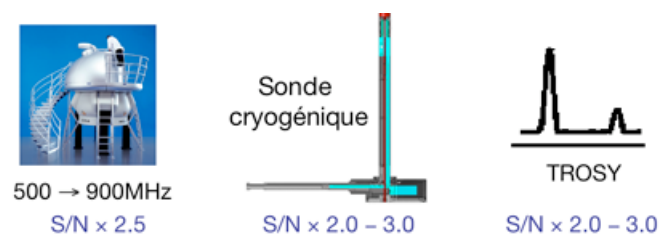
FIGURE 4: Quelques exemples d'amélioration technique ou spectroscopique des expériences RMN permettant un gain important en sensibilité.
