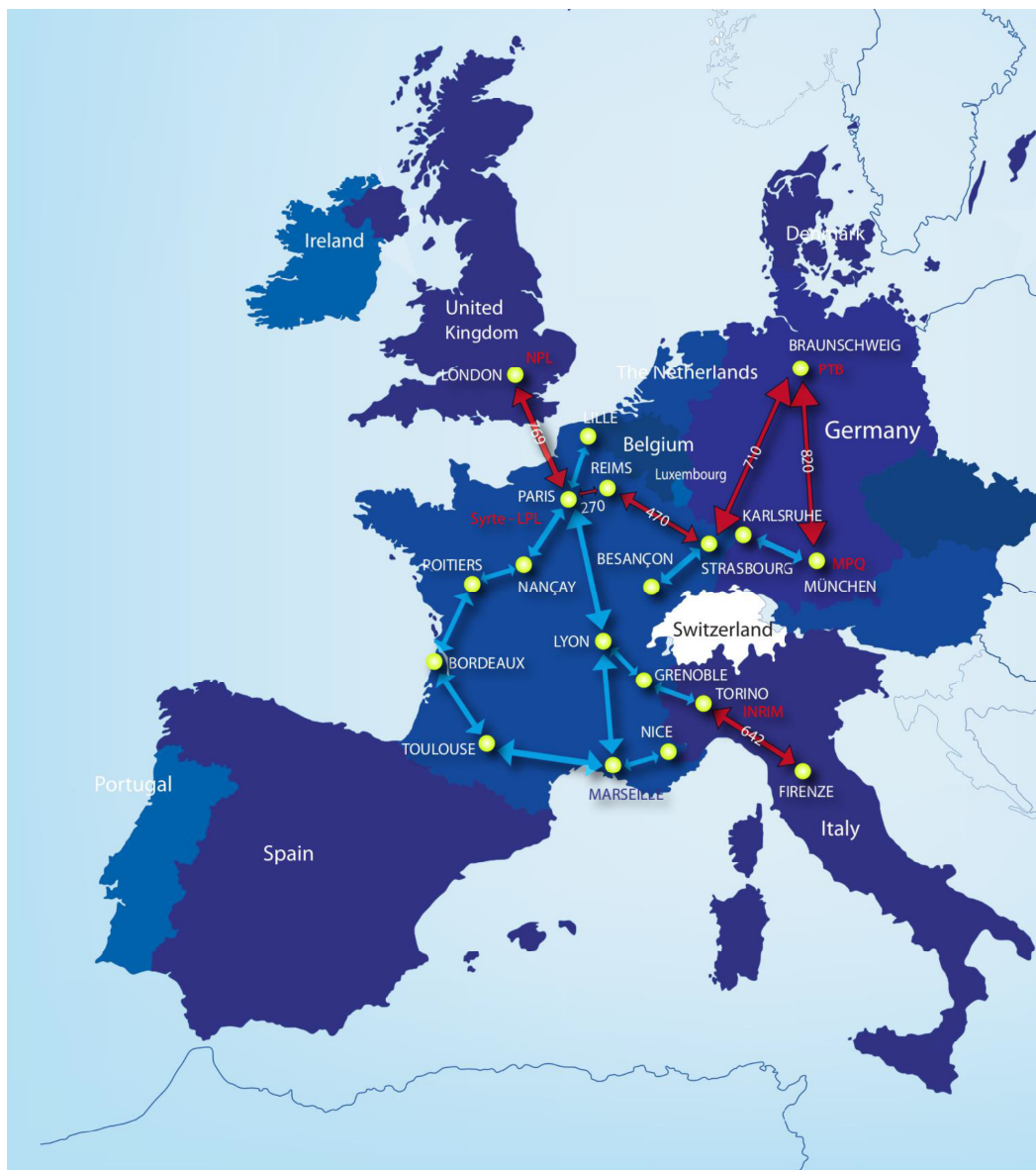
FIGURE 1.8 – Carte du déploiement du réseau météorologique Refimeve+ avec le signal optique de référence provenant du SYRTE (Paris) disséminé vers 19 partenaires scientifiques en France, et vers des connections européennes représentées en rouge avec l’Allemagne pour le PTB, l’Angleterre pour le NPL et l’Italie pour l’INRIM.
