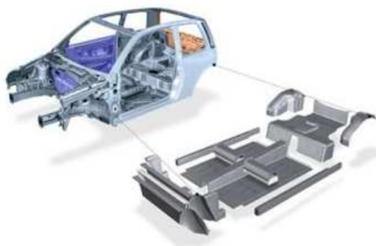
FIGURE 1.1 – Illustration des éléments d'un châssis d'automobile.
