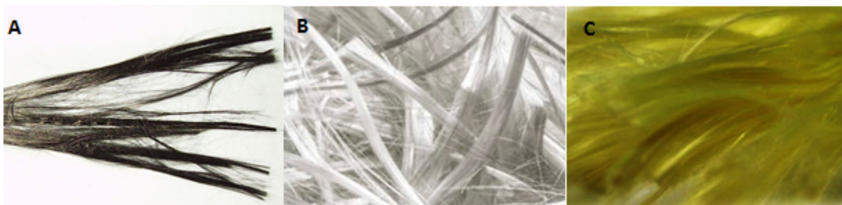
Figure II : fibres communément rencontrées dans les matériaux composites à matrice organique. A) carbone ; B) verre ; C) aramide.
