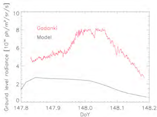
FIGURE 7.36 – Évolution de la luminance observée au sol durant la nuit du 29 mai 2014 à Gadanki. En rouge, l'observation à l'aide d'une caméra InGaAs et en noir, d'après le modèle. Les évolutions ainsi que les niveaux d'intensité diffèrent notablement.
