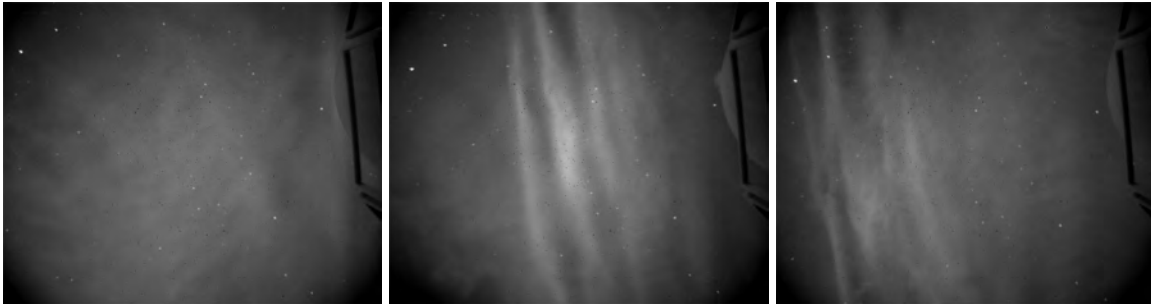
FIGURE 4.13 – Passage d'un front d'onde de gravité. À gauche, avant le passage de l'onde. Au milieu, point culminant de l'onde de gravité. On observe que la seconde ligne est plus intense que la première. Sur la troisième image, l'onde est passée et la trainée est encore visible sur la gauche. La luminosité et le contraste ont été modifiés sur ces images pour une meilleure visibilité sur le manuscrit.
