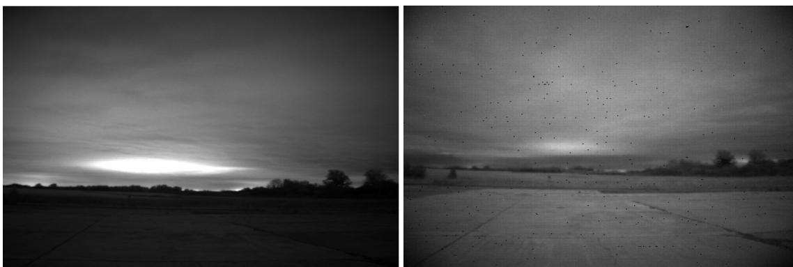
FIGURE 4.5 – À gauche, image dans le visible de l’éclairage public sur Vouziers, situé à 32 km et réfléchi par les nuages. Ici, le temps d’intégration est de 10 secondes. À droite, la même scène observée dans le proche infrarouge. Le temps d’exposition est de 0.8 seconde. Les spectres des figures 4.6 correspondent à ces images.
