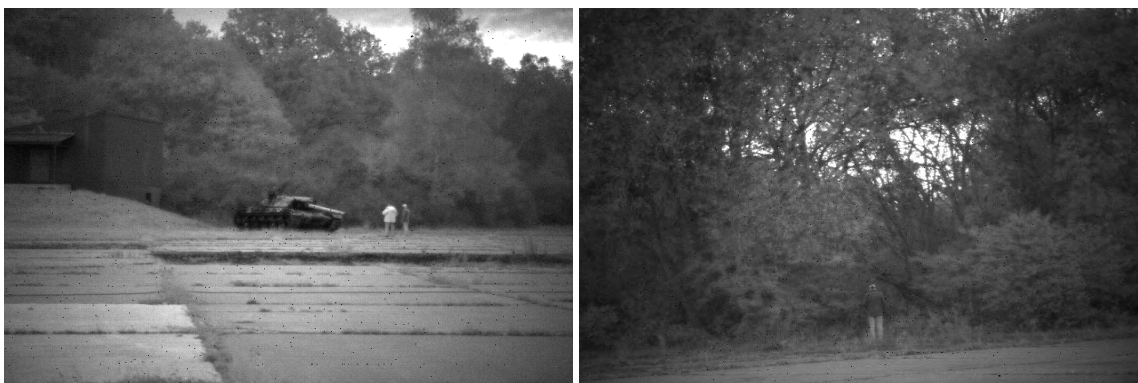
FIGURE 4.4 – À gauche, observation d’une scène entre deux marguerites (une marguerite étant une aire de parking avion). Le temps d’intégration est de 500 ms, et le luxmètre indique 2 mlx (nuit de type 3/4). À droite, observation d’une scène sous canopée. La silhouette est à 3 mètres de la lisière. Le temps d’intégration est de 900 ms, et le luxmètre indique 0.5 mlx (nuit de type 5). On distingue à travers la canopée le fond du ciel illuminé et saturé par l’émission du nightglow.
