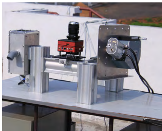
FIGURE 4.15 – Photographie des instruments ONERA déployés. À gauche, la caméra SWIR orienté au zénith, au centre, la caméra visible, et à droite, le spectroradiomètre.
