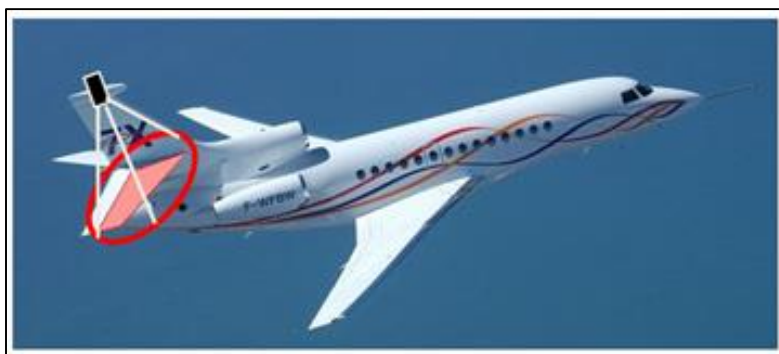
Figure 72 : photographie du Falcon 7X en vol. La caméra infrarouge est positionnée au sommet de la dérive.
