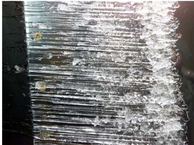
FIGURE 2.5 – Exemples de ruisselets congelés derrière la zone de captation de gouttes. L'écoulement est dirigé de gauche à droite.
