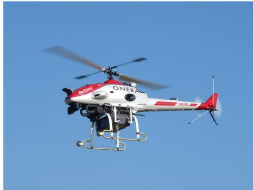
FIGURE 6.7 – Photo de l'hélicoptère Yamaha Rmax de l'Onera adapté au vol autonome.
