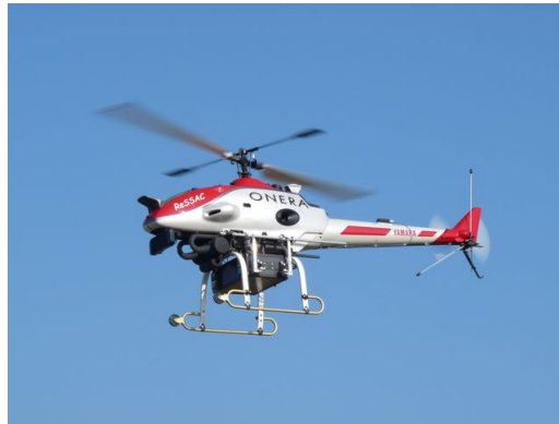
FIGURE 6.7 – Photo de l'hélicoptère Yamaha Rmax de l'Onera adapté au vol autonome.
