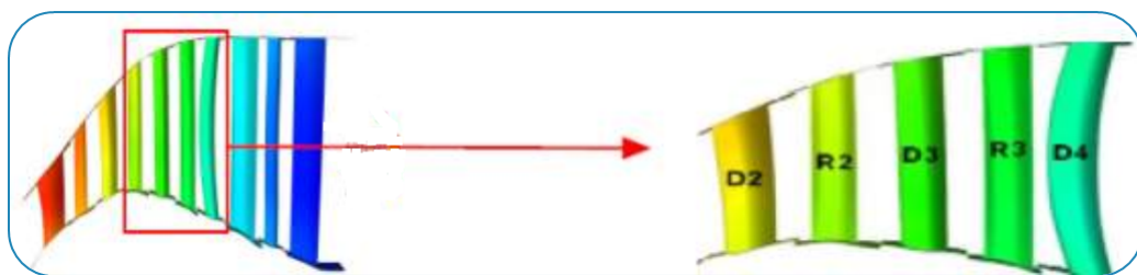
FIGURE VI.7 – Vue en coupe de plusieurs étages de roues. Un étage comporte une roue mobile “R” et une roue fixe “D”.
