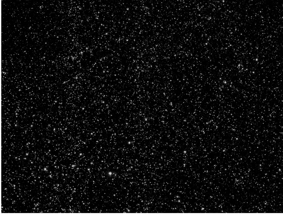
FIGURE 4.1 – Image de particules 2D de taille 1200 \times 1600 et de densité expérimentale de particules de 0,035 ppp.
