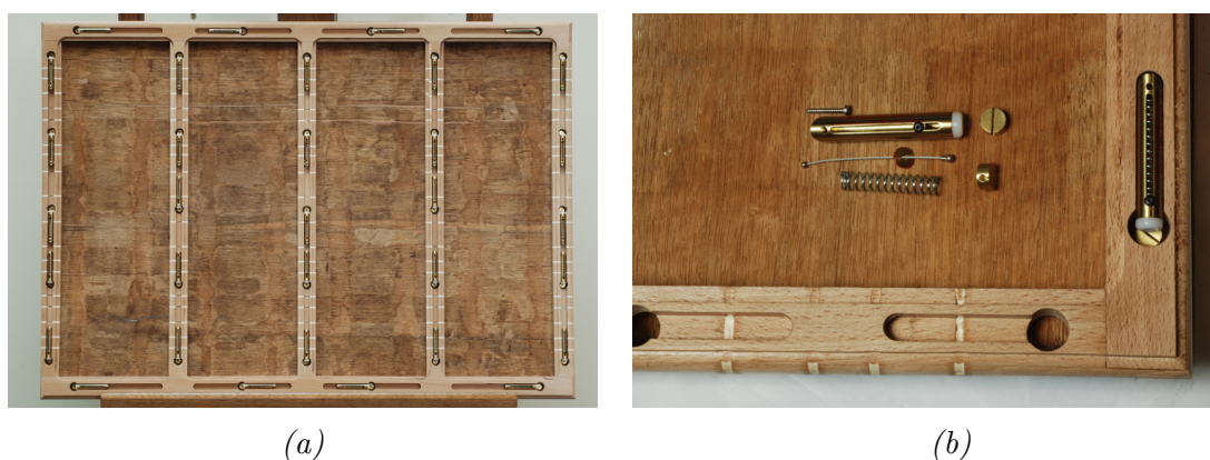
FIGURE 1.34 – (a) : Photo d'un cadre auxiliaire utilisé par José de la Fuente au musée du Prado à Madrid. ©Museo nacional del Prado. (b) : Exemple de ressort utilisé avec le cadre auxiliaire présenté en (a). ©Museo nacional del Prado.
