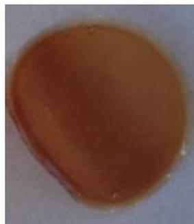
Figure 70: Membrane perfluorosulfonate de lithium sur support téflon (EO/Li-11)
